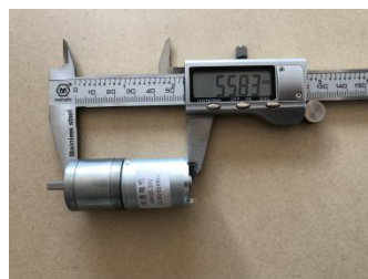
电机总长度不超过 60mm
