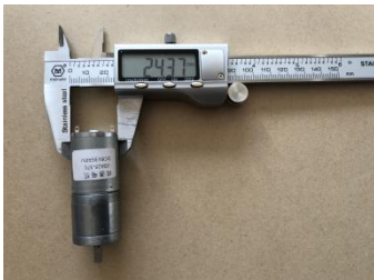
电机外径不超过 25mm
