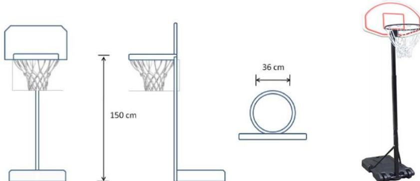
采用迷你篮球架：链接。上图的篮筐高度(150cm)、篮筐直径(36cm)根据采购篮筐的具体尺寸可能略有变化（篮筐高度 150–165cm、篮筐直径 35–45cm），以比赛时提供的篮筐尺寸为准。
