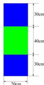
4. 定位柱，为直径 20cm，高 1m 的圆柱，颜色为蓝绿相间，可用相应 PPR 管切割而成，粘贴相应颜色贴纸。
